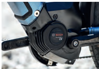
Kompakt und leistungsstark: der Bosch Performance CX-Motor.
