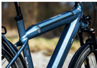
Extra-Reichweite: Dual-Batterie in Ober- und Unterrohr.
